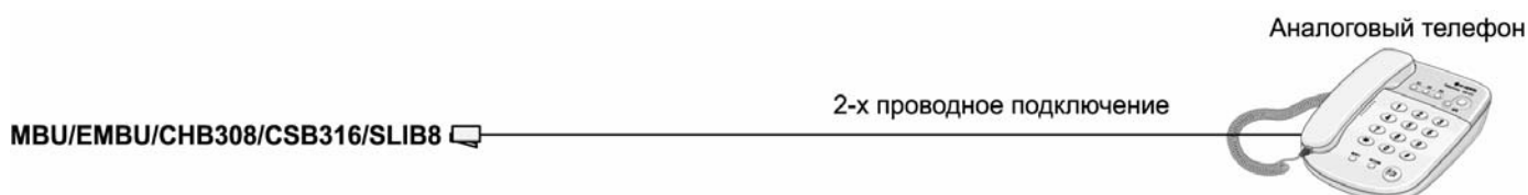
Рис. 2.22 Подключение аналогового аппарата
