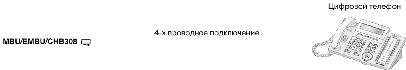
Рис. 2.21 Подключение цифрового аппарата и консоли DSS
